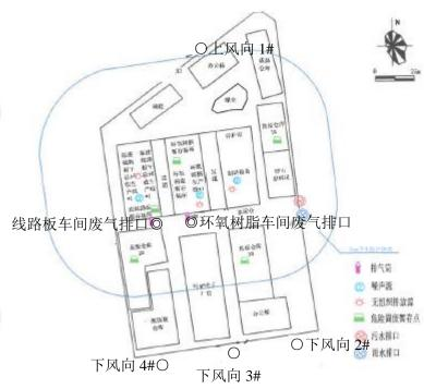
说明: ○废气无组织采样点 ◎废气有组织采样点
